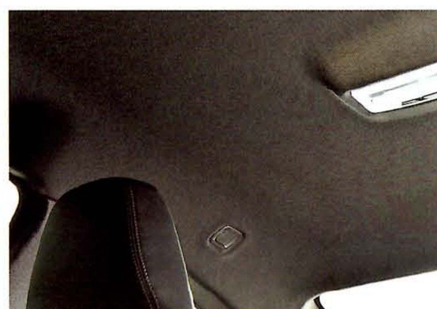
↑4チャンネルセットはAピラーと天井の内装材の内側にドライバを取り付ける。M4のようなクーペでも4チャンネルセットの取り付けは可能だ
