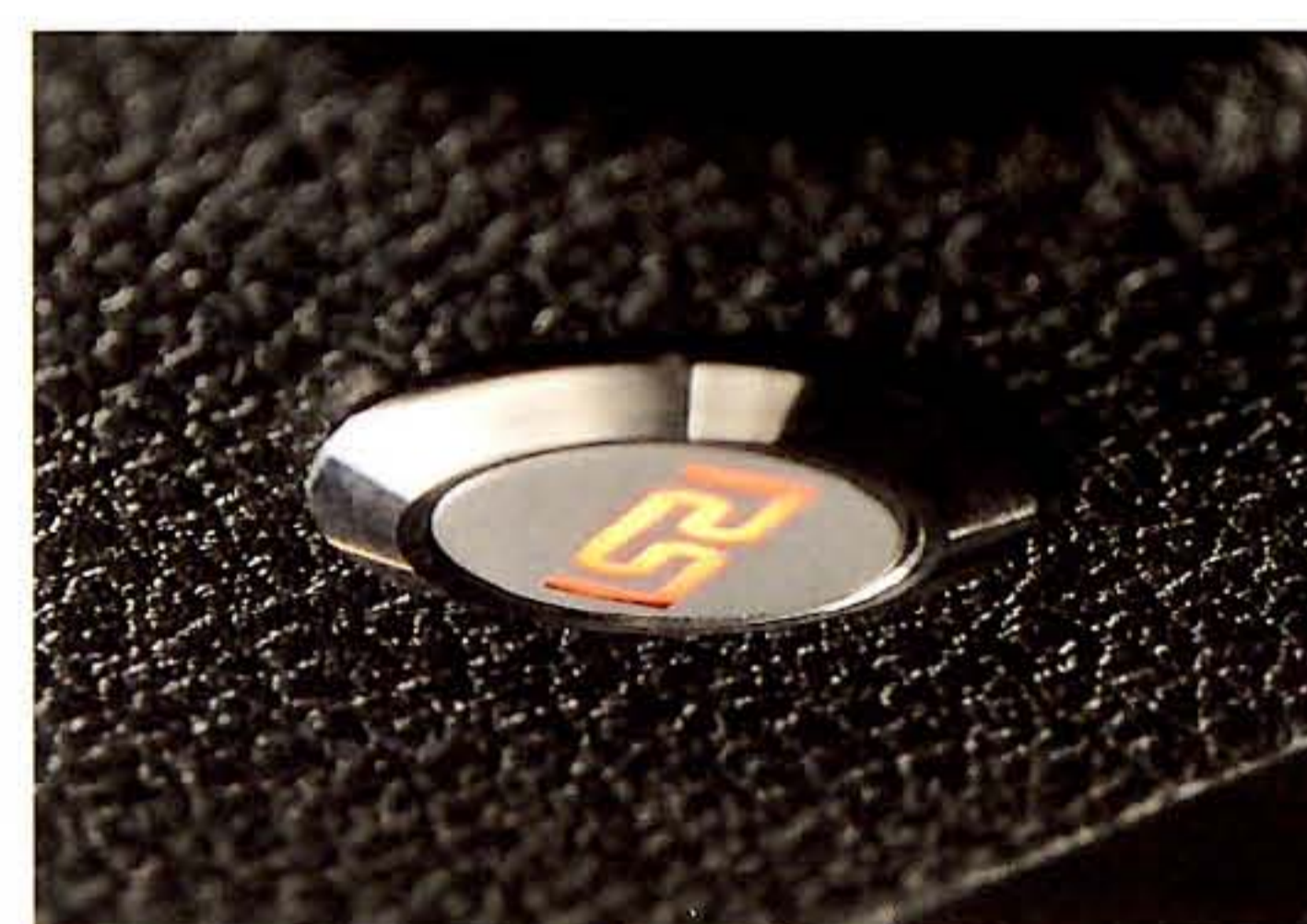
↑任意のスペースに取り付けることができる切り替えスイッチ。大きさは指の先端ほど。デモカーは目立たない運転席の足元に取り付けられている
